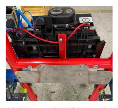
Vor dem Austausch ist die Demontage der Mulde bzw. des Schubkarrenaufbaus erforderlich.
